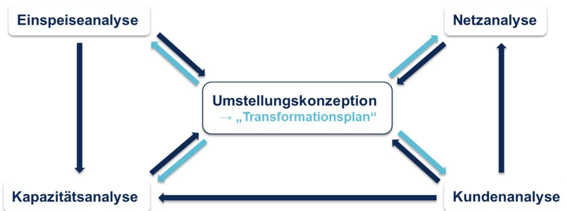
**Abbildung 6-1: Transformationsplanung zur Umstellung eines Netzgebiets auf H<sub>2</sub> nach dem GTP-Leitfaden 2024<sup>227</sup>**
