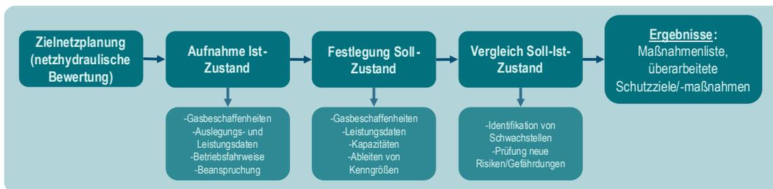
Abbildung 6-2: Prozessschema zur netzhydraulischen Analyse: Zielnetzplanung<sup>234</sup>
